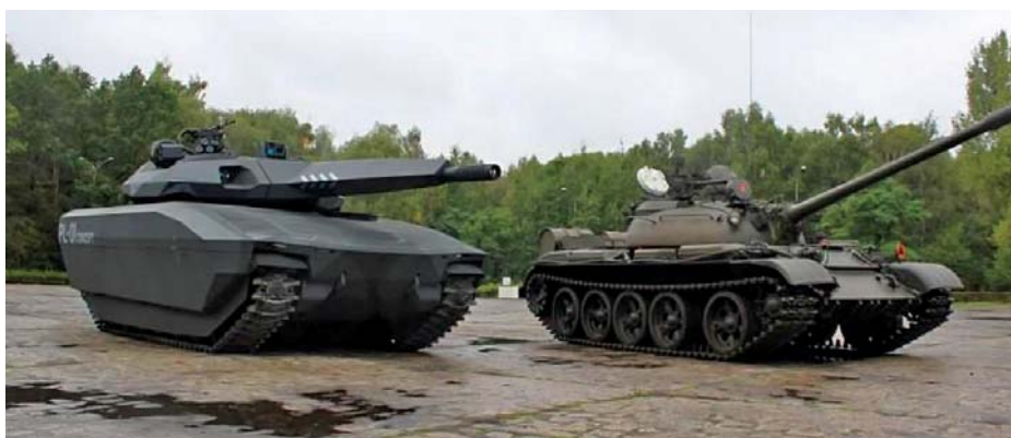
Возило PL-01 поред тенка Т-55. Иако дужина тенка PL-01 није превелика – седам метара, јасно је да је ширина, захваљујући оклопу преко гусеница, чак 3,8 t, а висина значајних 2,8 t, захваљујући високом ширину.
